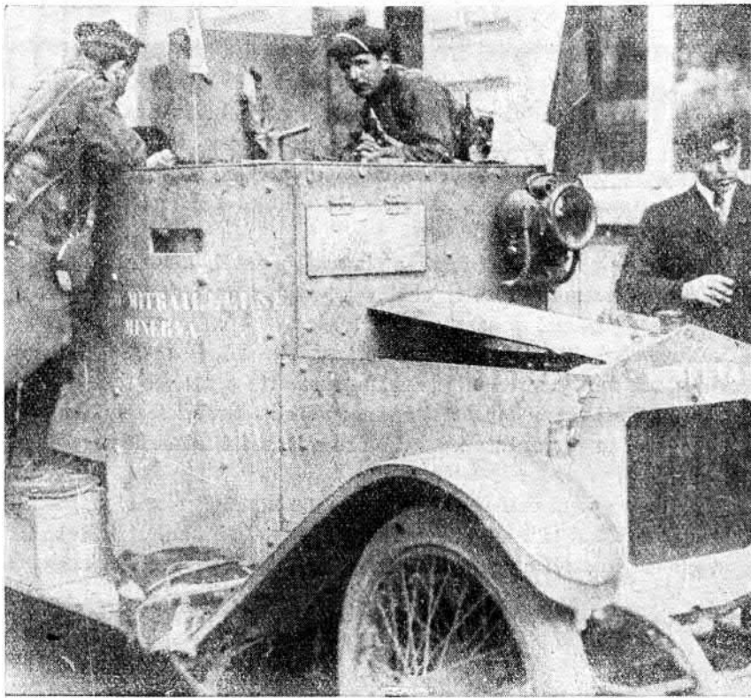
Golyósóróval fölszerelt belga páncélos automobil. A modern háború a technika minden vívmányát a maga szolgálatába állította. A páncélaútó a legveszedelmesebb területen is sikerrel végezhetett kémiszolgálatot, mert az ellenség tüzelése nem ártott neki: páncélfalairól tehetetlenül pattantak le a golyók
