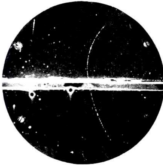
9. ábra. Első ködkamrás felvétel, melyen a pozitron pályanyoma látható.
