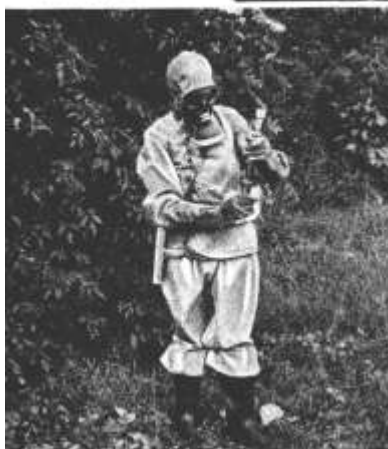
A GÁZFELDERÍTŐ KÉMLŐ- CSÖVÉBE KÉMIAI REAK- CIÓT ELŐÍDEZŐ FOLYADÉ- KOT CSŐPPENT.
