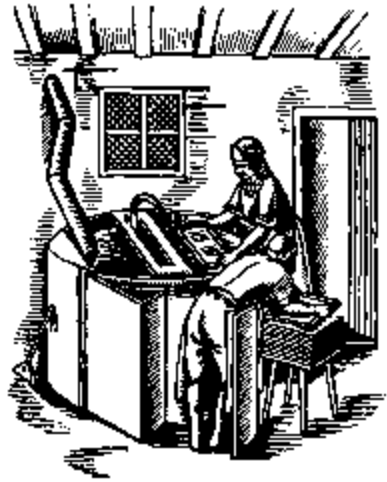
Vízikerékkel hajtott rongyúzó mű. Merítőmester
