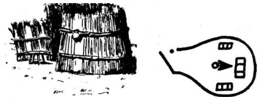
128—129. ábra. Vasaló képe és alaprajza. Ovális alakú nádfalazat a tűzhely védelmére. Fala 2-3 korcú s felül a nád bokrétája le van nyírva, hogy a tűz bele ne kapjon. Hortobágy.
