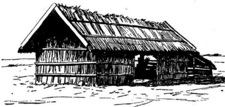
89. ábra. Nádból készült juhodály, átmenete a házszerű épülethez. Fala és fedele léckorc közé szorított nád. Fedelét faoszlopok tartják. Fedélszéke gerendából, rudakból, lécekből áll. A jobboldali végén levő félszer a pásztorok tanyája. Karcag.
