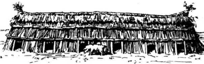
86. ábra. Régimódi disznóhóidály nádból. Hosszúak ovális alaprajzú nyerges fedelű nádkunyhó kettős korccal és gerincén leszegett éllel; két végén konttyal. Mindkét oldalán 6-6 ajtóval. A sok ajtó azért volt szükséges, mert a disznónyáj tömegesítő rohant be, vagy ki éa egy ajtón járva összetörték volna egymást. Türkeve—Ecseg.
