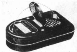
Weston-féle megvilágításmérő. (Amer. Cinematographer nyomán.)
